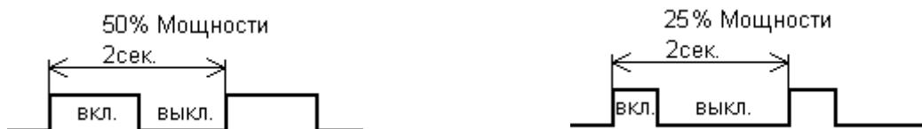
Если зеленый светодиод светится постоянно, то это означает 100% мощность вентилятора, и соответственно если не светится совсем то 0% мощности. Следует заметить, что при расчетной мощности менее чем 20% прибор отключает вентилятор полностью.
