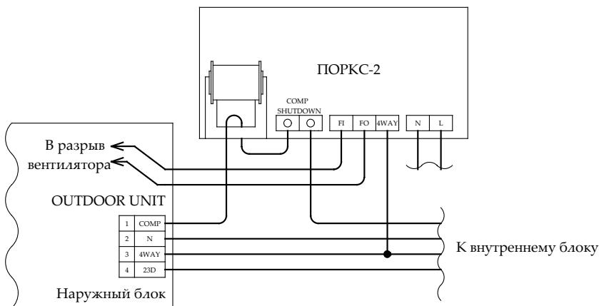
На схеме сверху показана только часть схемы одинаковая как для применения и.к. рестарта, так и без него. **В случае применения и.к. рестарта и установки ПОРКС-2 рядом с внутренним блоком необходима прокладка дополнительного кабеля для управления вентилятором наружного блока!**
