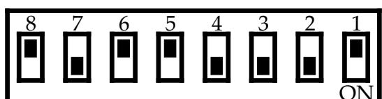
Диапазон токов, который можно установить с помощью DIP переключателя (перемычек) от 0 до 25,5А, что перекрывает все разумные токи и мощности компрессоров кондиционеров, в которых можно применить ПОРКС-2.
