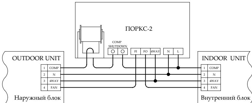
В схеме выше присутствует провод управления вентилятором наружного блока. По предлагаемой схеме ПОРКС-2 можно установить в любом месте от внутреннего блока, и заканчивая установкой внутри наружного блока.
