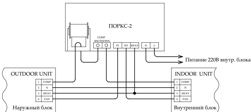
Установка ПОРКС-2 в бытовой кондиционер, в котором нет прямого управления вентилятором наружного блока.
