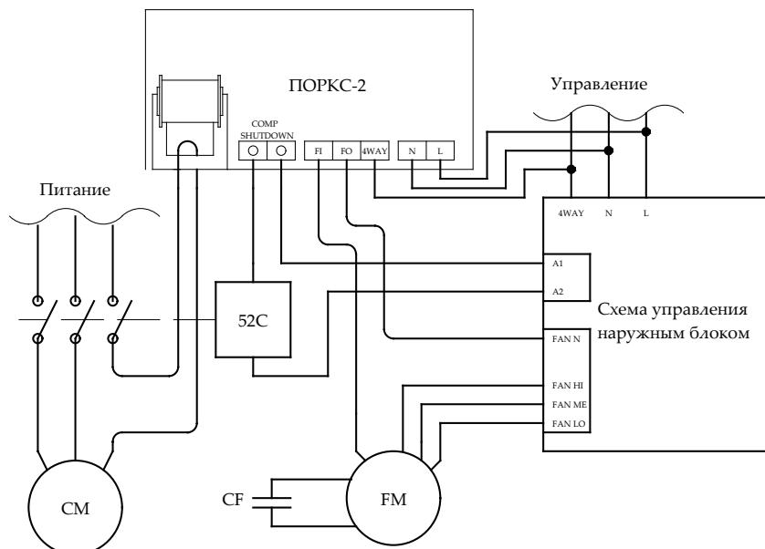
Приведенные схемы включения обобщенные. Конкретная схема включения зависит от типа кондиционера, его модификаций, вкуса монтирующего ПОРКС-2, пожеланий заказчика и т.д. и т.п. Поэтому при включении прибора следует руководствоваться общими замечаниями по установке ПОРКС-2 в п2.
