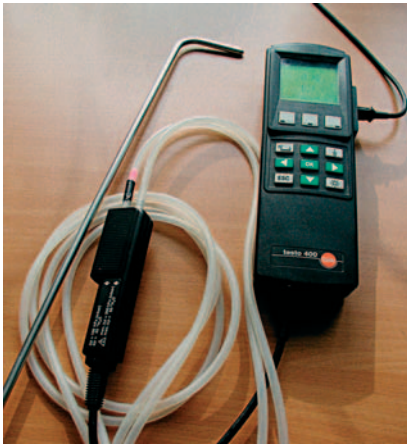
Рис. 12.9.3. Трубка Пито для измерения давления воздушного потока (из комплекта Testo-950)
