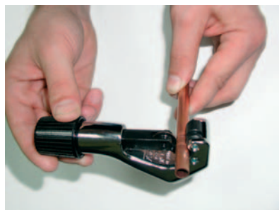
Рис. 12.4.3. Резка медной трубы труборезом
