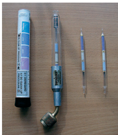
Рис. 12.7.7. Прибор для оперативного определения степени влажности хладагента
