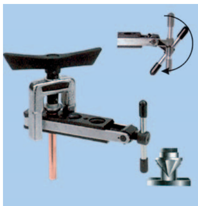
Рис. 12.4.10. Вальцовки: а – с конусным пуансоном; б – с фигурным пуансоном
