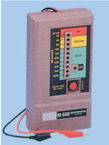
Рис. 12.9.1. Мегометр для измерения сопротивления изоляции
